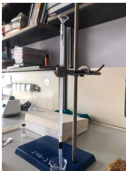
Рисунок 9 - Процесс пропускания наночастиц на основе аллиламина и бисакриламида через криогели
