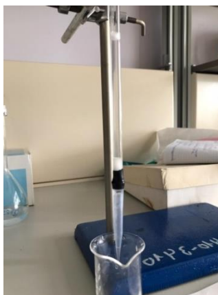
Рисунок 3 - Процесс пропускания цетилпиридиний бромида через криогель состава 30:15:55
