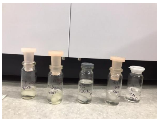
Рисунок 6 - Процесс сорбции лекарственных средств криогелей модифицированных и не модифицированных ванилином (первые два образца – модифицированные ванилином криогели состава 30:30:40).
